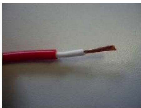
Obr.4 Dvojitá izolace vodičů
