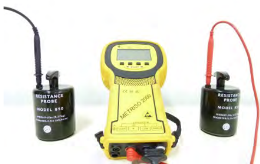
Obrázok 10 WW MetrISO 2000 (meranie R_g , R_{gp} , R_{p-p} , R_s )
