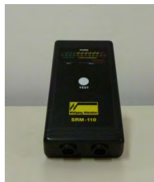
Obrázok 12 WW SRM-110 (meranie R_g , R_{p-p} )
