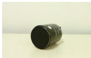
Obrázok 13 Meracia sonda Model 850 (meranie R_g , R_{gp} , R_{p-p} , R_s )
