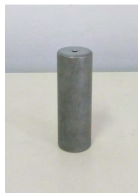
Obrázok 14 Meracia sonda Model 45 (meranie R_g -systémový test)
