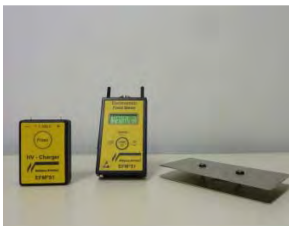
Obrázok 11 WW EFM 51.CPS (meranie účinnosti ionizácie)
