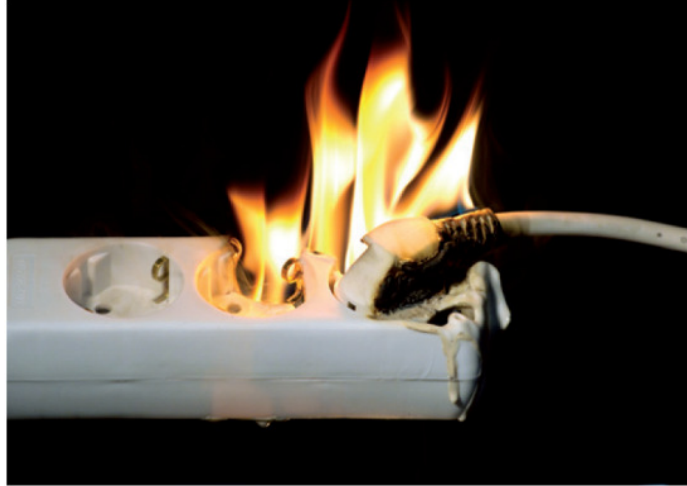
Obr. 4 Následek špatného kontaktu v obvodu bez obloukové ochrany AFDD
